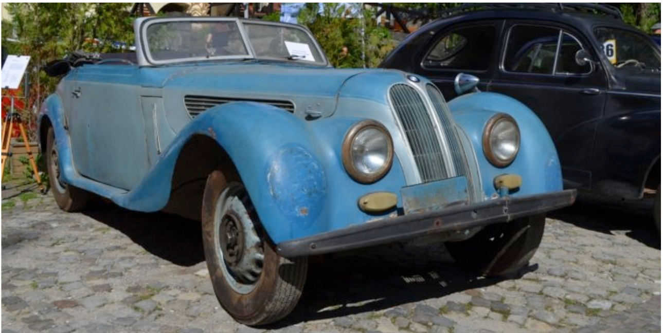
BMW 327 Baujahr 1937 ; keine Sicken, Motorhaube über Seiten gezogen, Türanschlag an der B-Säule, Scharniere sichtbar an der A-Säule.
